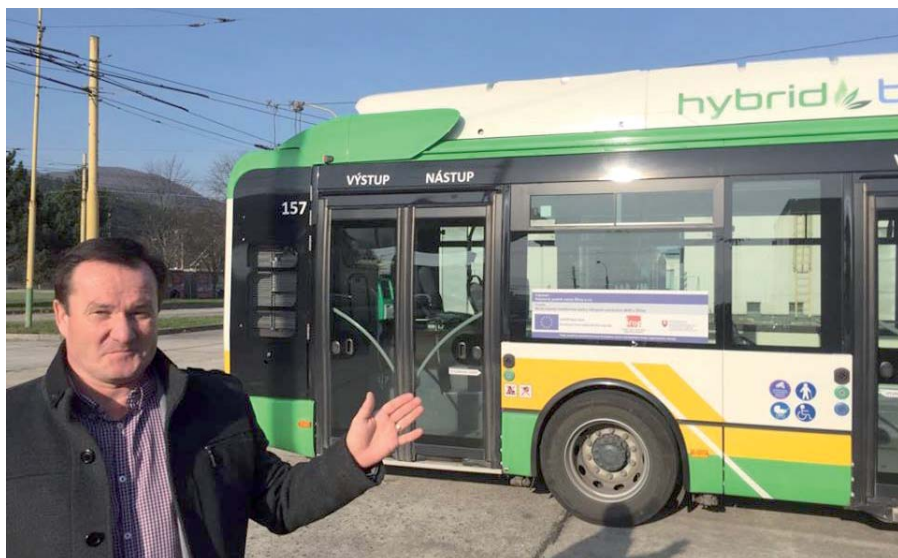
Riaditeľ DPMŽ Ján Barienčík ukazuje, že hybridný autobus má batérie na streche.
